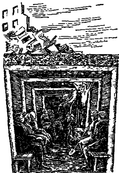
Рис. 24. Устройство проема в перекрытии для выхода людей из заваленного укрытия
